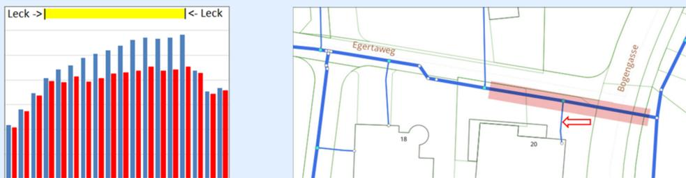
Digitale Wasserbilanz zur Früherkennung der Verluste - in Folge Zuweisung der Wasserverluste auf das Leitungsobjekt durch Datenvernetzung und mit Hilfe künstlicher Intelligenz
